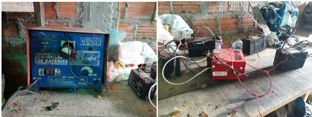
Figura 5: Carregador e baterias - utilizadas para a iluminação da pesca. Fonte: Dos Anjos (2021)
